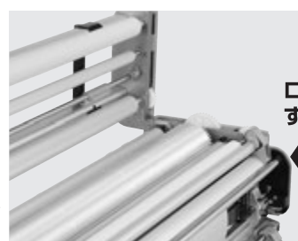
第8図 奥まで入れてロックする。 (収納状態) (出荷状態)
