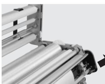
第10図 ゆっくり開きセットの位置で止め ます。
