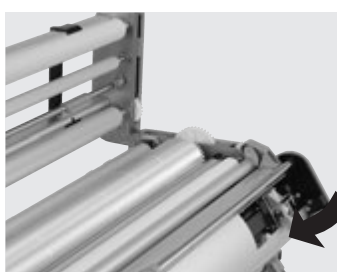
第7図 スリッターフックを少しくかせます。
