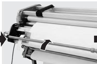
壁紙を通してスリッターテンションバーを矢印方向へ閉じます。
