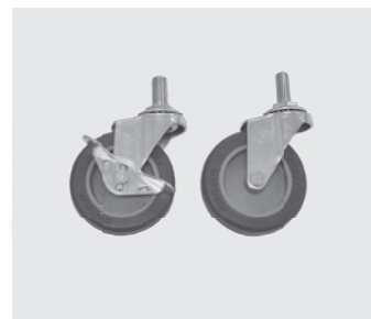
408-642 φ75mmキャスター(ストッパー有) 408-643 φ75mmキャスター(ストッパー無) ※薄型スパナ(19×21mm)を使用し、標準キャスター(φ100mm)と交換できます。
