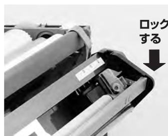
第11図 下方へ押ししてセット完了します。
