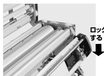
第11図 下方へ押してセット完了します。
